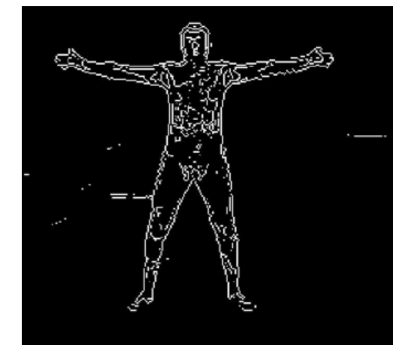
Fig. 6: Application of edge detector „Sobel“
