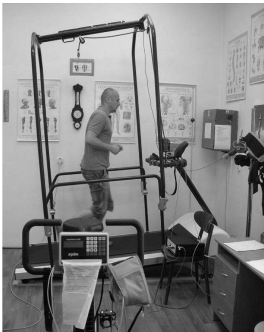
Obr. 2: Ergometrické vyšetření sportovce na chodníkovém ergometru. Na tomto chodníku lze nastavit rychlost pásu až do 25 km/hod a sklon do 20 %.
