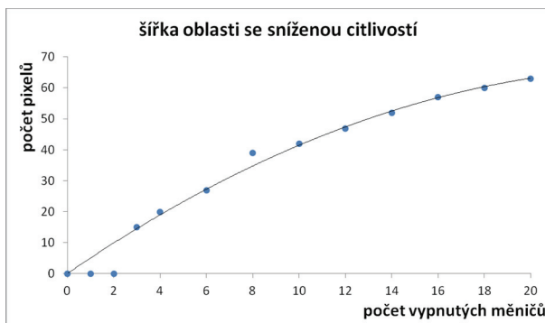
Obr. 14: Šířka oblasti se sníženou citlivostí – závislost na počtu vypnutých měničů.
