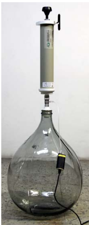
Obr. 1: Sestava pro měření poddajnosti modelu respirační soustavy (v tomto případě rigidní nádoby) s napojeným senzorem tlaku.
