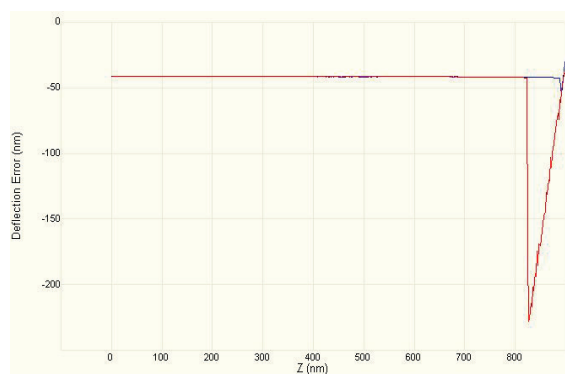
Obr. 3: F-d křivka sloužící k vyhodnocení optimální silové interakce mezi zobrazovaným vzorkem a zobrazujícím hrotem v ScanAsyst režimu. Osa X reprezentuje vzdálenost mezi hrotem a povrchem vzorku ( Z [nm]), osa Y reprezentuje síly působící mezi hrotem a povrchem vzorku, resp. odchylku nosníku (deflection error \delta [nm]).
