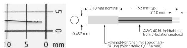
Fig. 1. Thermistor NTC 2K7MCD1.
