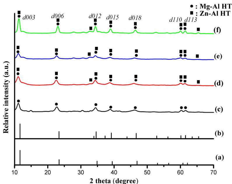
FIGURE 1. Diffractogram of (a) JCPDS Mg-Al-HT (b) JCPDS Zn-Al-HT (c) Mg-Al-HT (d) Mg-Zn1-Al HT (e) Mg-Zn2-Al HT (f) Mg-Zn3-Al HT.
