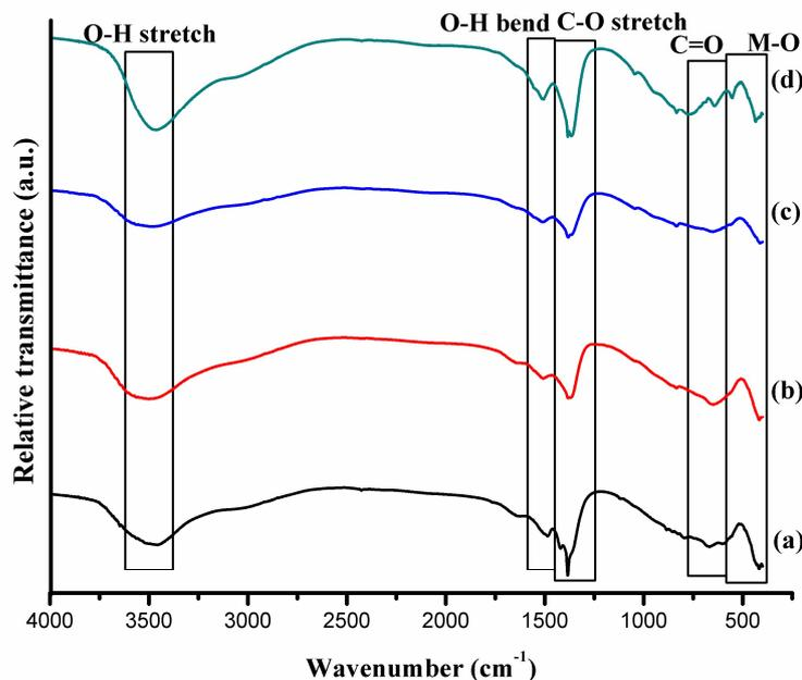
FIGURE 2. FTIR spectra of (a) Mg-Al-HT, (b) Mg-Al-Zn1-HT, (c) Mg-Al-Zn2-HT, (d) Mg-Al-Zn3-HT.
