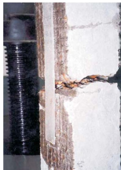
Fig. 2: FRP-concrete bond test
