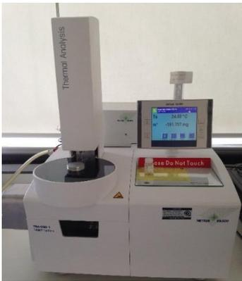
Fig. 4 Thermogravimetric analyzer
