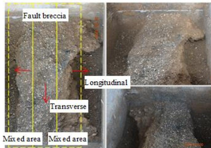
Fig. 10 – Picture of grout diffusion mode
