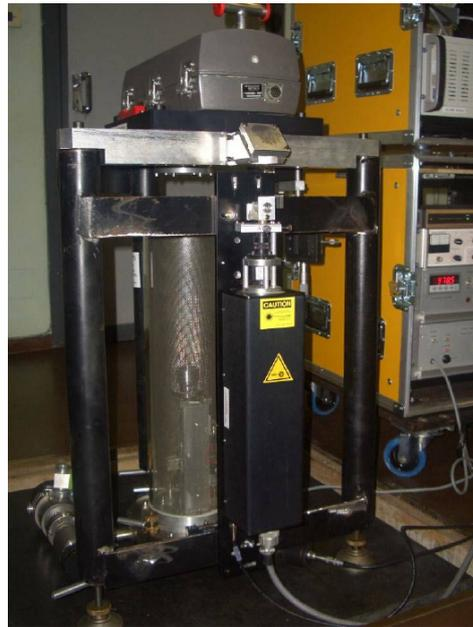
Figure 2: Absolute gravimeter IMGC-02.
